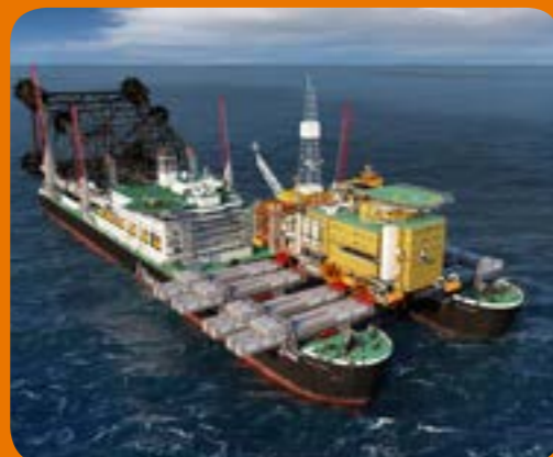
Superhefschip en pijpenlegger Pioneering Spirit
