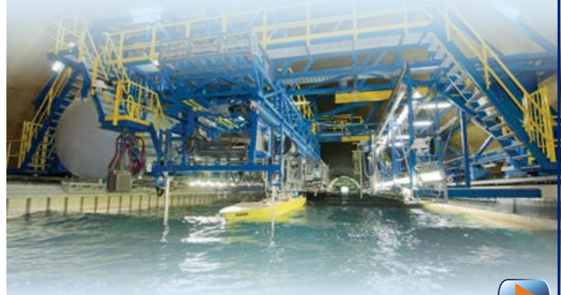
Model in golven onder de sleepwagen in de Lagedruktank in Ede
